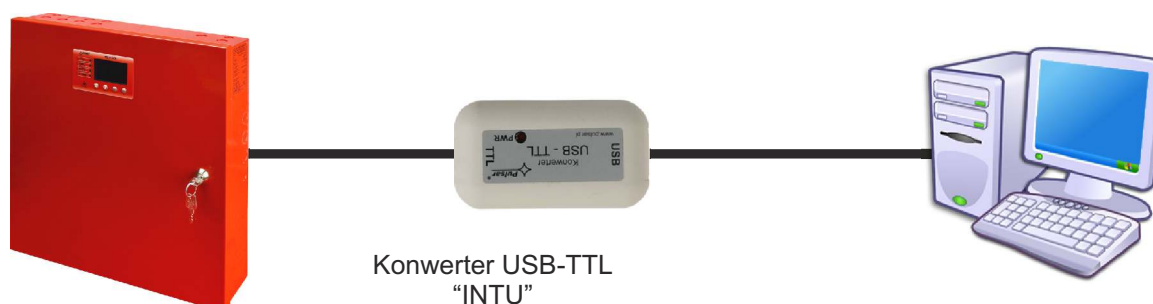
Komunikacja USB-TTL z wykorzystaniem interfejsu USB-TTL „INTU”.
