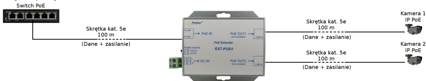
Podłączenie dwóch kamer IP PoE i wydłużenie zasięgu o kolejne 100m
