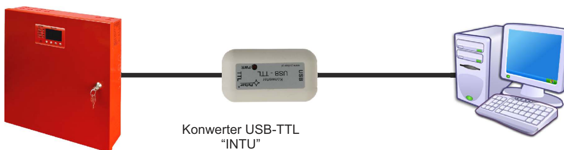
Komunikacja USB-TTL z wykorzystaniem interfejsu USB-TTL „INTU”.
